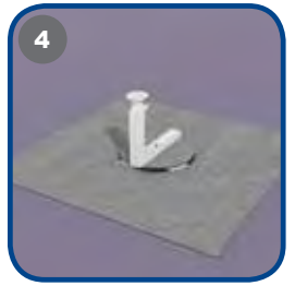
4 Skjær opp hullet, og fjern knivfoten, kniven og mansjettbiten. OBS! Bruk riktig hull i Puruskniven.
