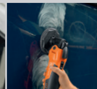
Fjern riper i billakken med poleringspute i filt og poleringsmiddel.
