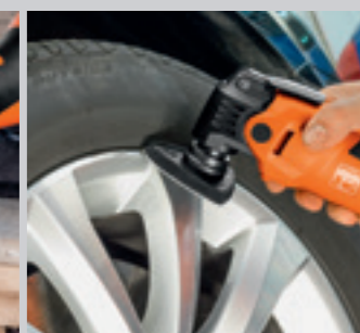
Spesialpapir med svært fine korninger egner seg perfekt til utbedring av lakkeringsfeil og feilområder.
