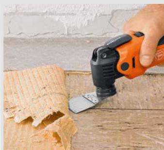
Med den stive sparkelen kan du fjerne tepegulv eller limrester raskt, enkelt og uten rester.
